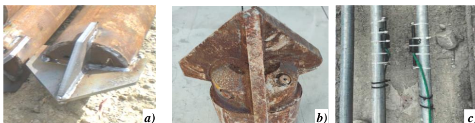
Figura 1: Particolare punta di perforazione: a) bassa pressione; b) alta pressione; c) estensimetri pronti per l'installazione
