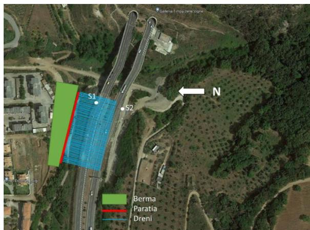
Figura 5. Planimetria delle opere in progetto per la fase 2
