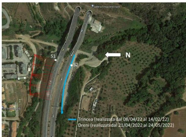
Figura 4. Planimetria delle opere in progetto per la fase 1
