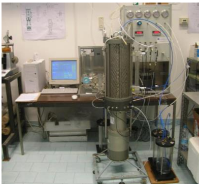
Cella triassiale (Bishop-Wesley) USP a stress path e suzione controllata
